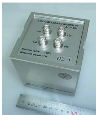
図 4-8 高安定金属箔抵抗素子を用いて製作した 4 端子対型抵抗器
