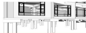
Pondasi Tiang Pancang Sub struktur yang berfungsi menahan gaya orthogonal ke sumbu tiang dengan cara menyerap lenturan dari bangunan
