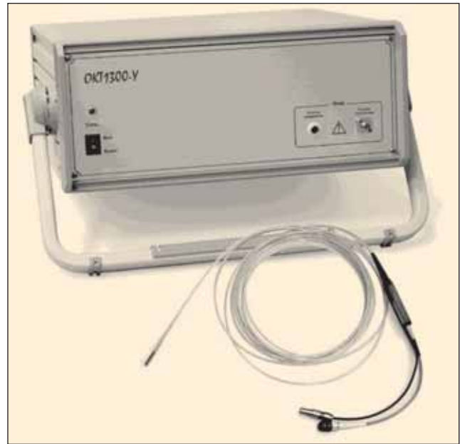
Рис. 4. Прибор для выполнения ОКТ с зондом, адаптированным для проведения через цистоскоп
