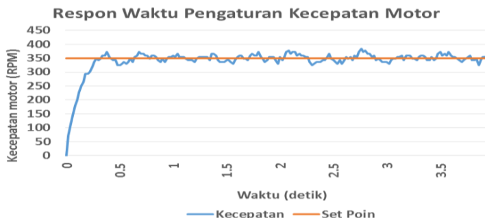
Gambar 8. Respon waktu kecepatan motor saat set poin 350 RPM.
