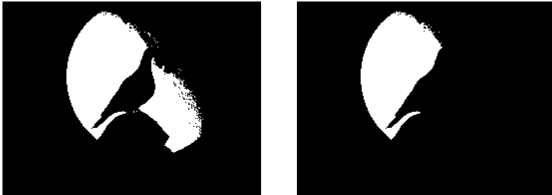
(a) (b) Gambar 6. (a) citra tersegmentasi, (b) citra setelah proses morfologi closing dan opening
