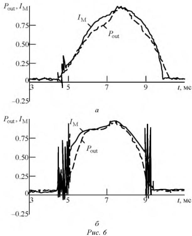
имеются две важные точки ЛМ 1 и 2, характеризующие работу магнетрона и цепей его питания. ЛМ 1 указывает на момент насыщения сердечника трансформатора, т. е. характеризует состояние последнего.
