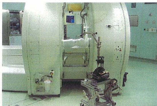
図3 マグネットのギャップに挿入されるロボット。
