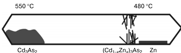
Рис. 1. Схема получения монокристаллов (Cd_{1-x}Zn_x)_3As_2 из паровой фазы
