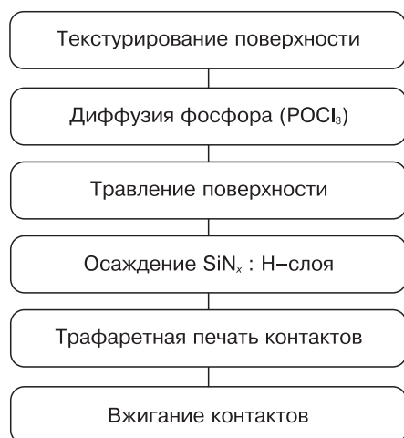
Рис. 1. Процесс производства солнечных элементов с архитектурой Al-BSF Fig. 1. Al-BSF Solar Cell Technology
