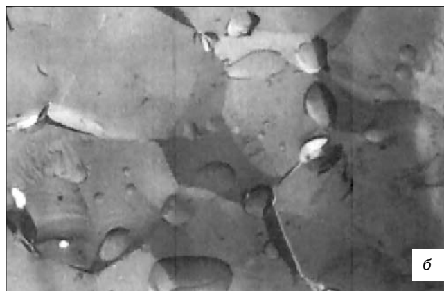
Рис. 5. Микрофотографии ферритов, полученных методом ДС с дошихтовкой ZnO: а — × 10000, d_c = 95\% , \sigma_{и} = 73 МПа, T = 1140 °С, t = 6 ч; б — × 9000, d_c = 97\% , \sigma_{и} = 114 МПа, T = 1140 °С, t = 6 ч + ПИВ (1030–6).
