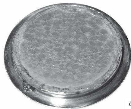
Рис. 1. Измерительная ячейка с использованием принципа синхронного детектирования на частоте модуляции 25–80 Гц и формированием сигнала с помощью бесконтактного электрода через регулируемый воздушный зазор (а) и внешний вид пирозлектрической мишени пироЭОПа на металлическом кольце диаметром 18 мм со стороны пирозлектрического слоя ДФТА, покрытого слоем никрома толщиной ~25 нм (б)
