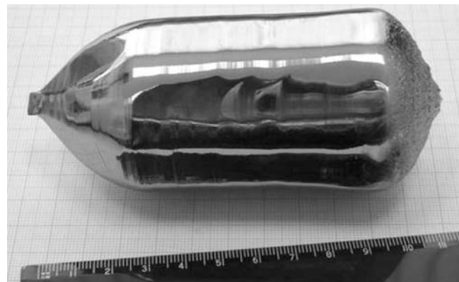
Рис. 1. Внешний вид нелегированного монокристалла антимида индия диаметром 62—64 мм, выращенного в кристаллографическом направлении [100]
