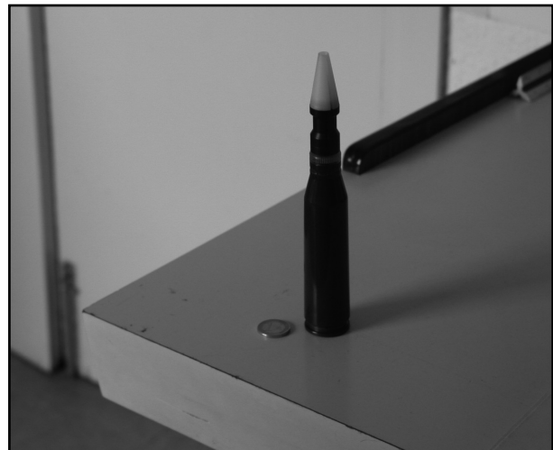
Figura 3. Proyectil de 20 mm APDS. Figure 3. 20 mm APDS projectile.
