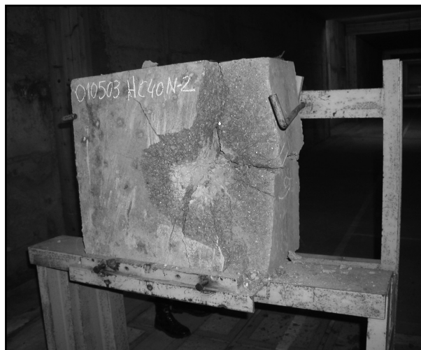
Figura 6. Impacto de proyectil de 25 mm APDS en placa-blanco de 40 mm de espesor de hormigón sin fibras de acero (frágil). Figure 6. Impact of 25 mm APDS projectile in a concrete without steel fibers plate-target of 40 mm thickness (fragile).
