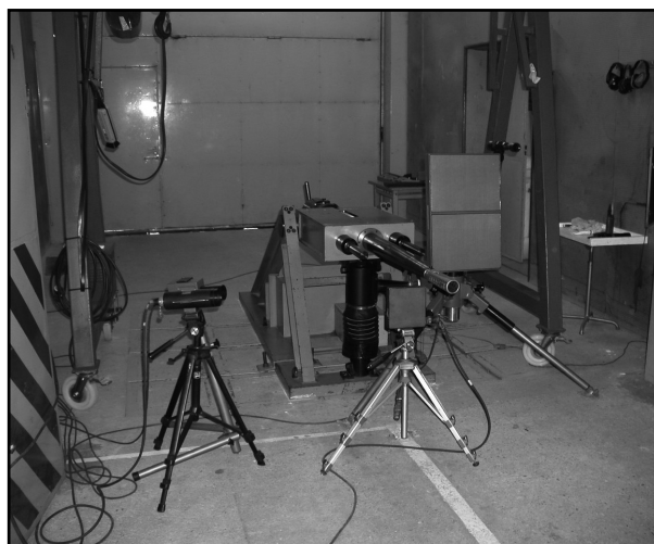
Figura 4. Cañón de 25 mm, radares Doppler y cámaras ultrarrápidas. Figure 4. 25 mm cannon, Doppler radars and extra fast camera.
