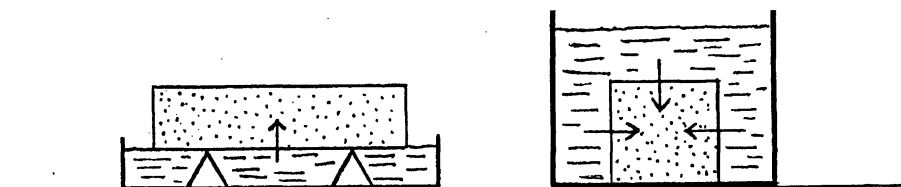
Figuras 1 y 2.- Ensayos de succión e inmersión. Las flechas indican el avance del agua absorbida. Figures 1 and 2.- Suction and immersion tests. The arrows show the advance of the absorbed water.
