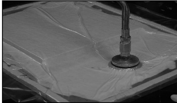
Figura 3. Aplicación de bolsa de vacío para compactación. Figure 3. Application of vacuum bag for compaction.
