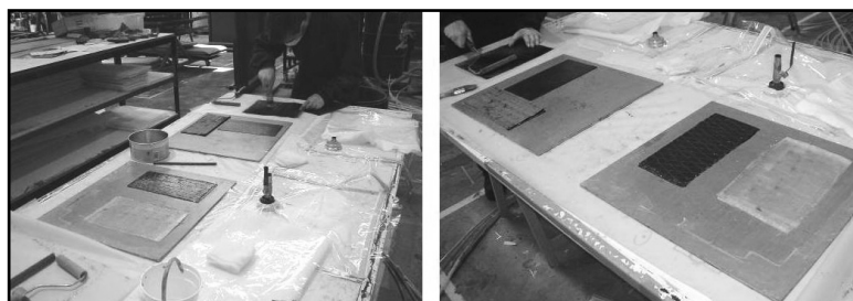
Figura 2. Impregnación, desburbujeo y compactación manual del estratificado. Figure 2. Impregnation, removal of entrapped air and hand compaction of the laminate.
