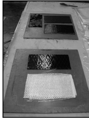
Figura 1. Refuerzo preparado para ser impregnado con la resina. Figure 1. Reinforcement ready for resin impregnation.
