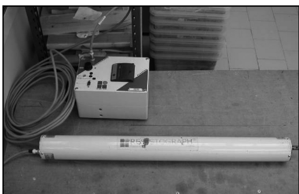
Figura 1. Resistógrafo empleado en el estudio. Figure 1. Resistograph used in this study.
