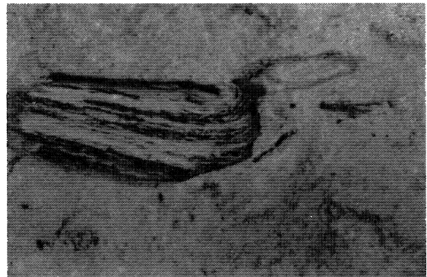
Figura 2.- Fibras de madera del mortero soporte del Retablo (microscopía óptica, x10,7).
