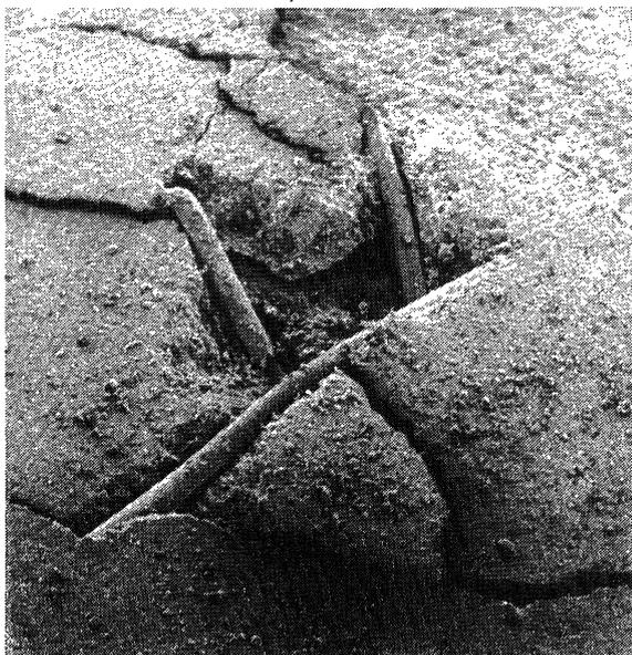
Fig. 5.—Muestra de compuesto fibra de cobre-cemento compactado fracturado por fatiga mecánica. Las partes rotas se mantienen ensambladas (20x).
