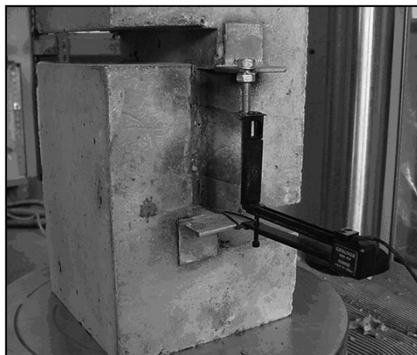
Figura 3. Instrumentación de la probeta doble - L. Figure 3. Instrumentation of the double - L shear specimen.
