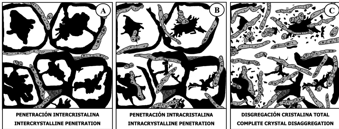
Figura 5. Diagrama de las tres fases de colonización fúngica en dolomías; A) Penetración intercrystalina: los hongos penetran en las dolomías a través de la porosidad intercrystalina propia de la roca; B) Penetración intracrystalina: Los hongos llegan a penetrar finalmente en el interior de los cristales dolomíticos; C) Disgregación cristalina total: Los cristales dolomíticos aparecen reducidos a fragmentos minerales microdivididos y englobados en el interior de una masa de hongos.
