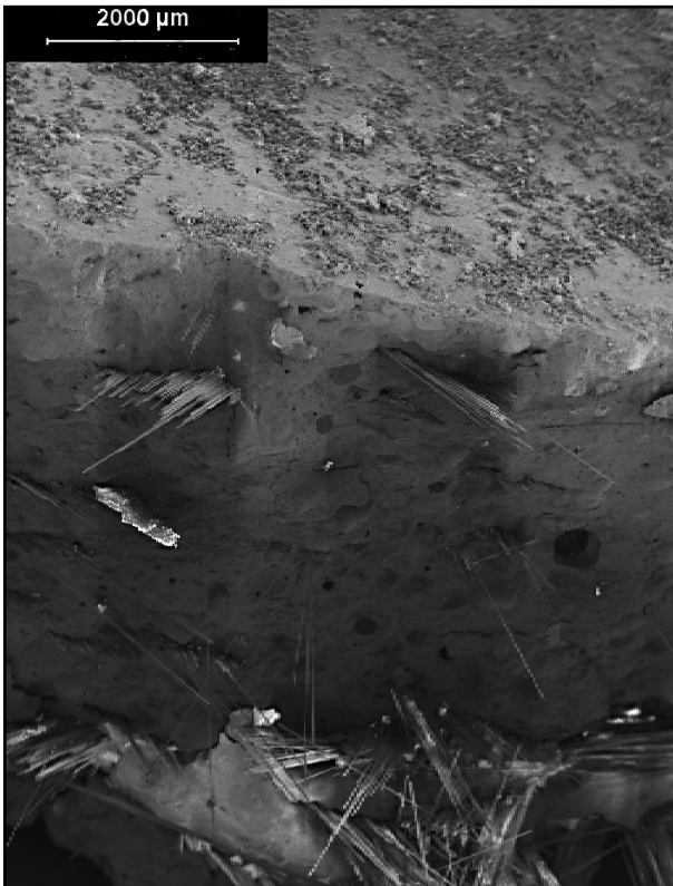
Figura 11. GRC con 20% humo de sílice envejecido durante 40 días. Figure 11. 40-day aged GRC with 20% silica fume.
