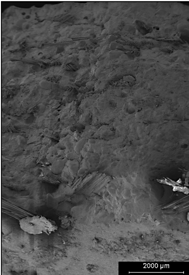
Figura 13. GRC con 10% humo de sílice envejecido durante 80 días Figure 13. 80-day aged GRC with 10% silica fume.
