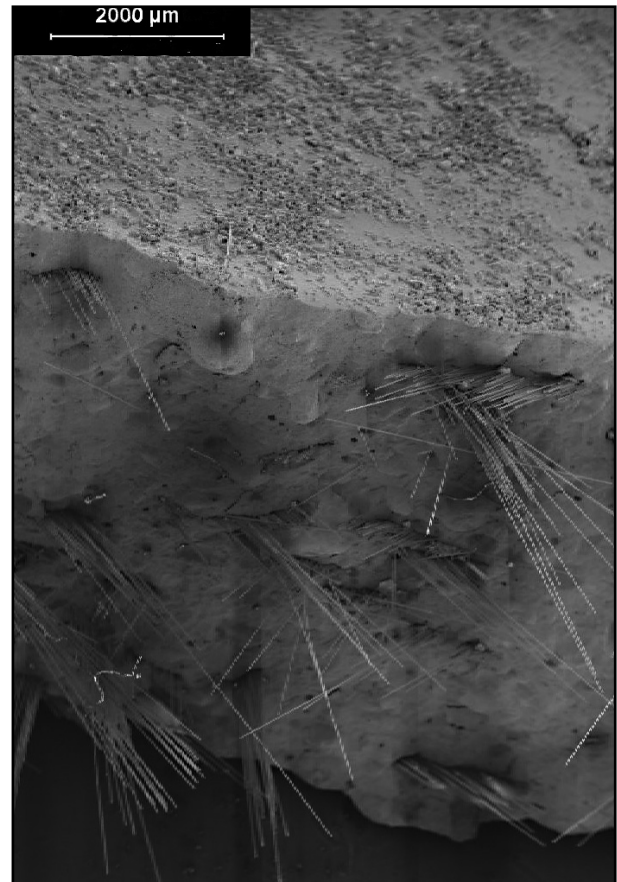
Figura 12. GRC con 10% metacaolín envejecido durante 40 días. Figure 12. 40-day aged GRC with 10% metakaolin.
