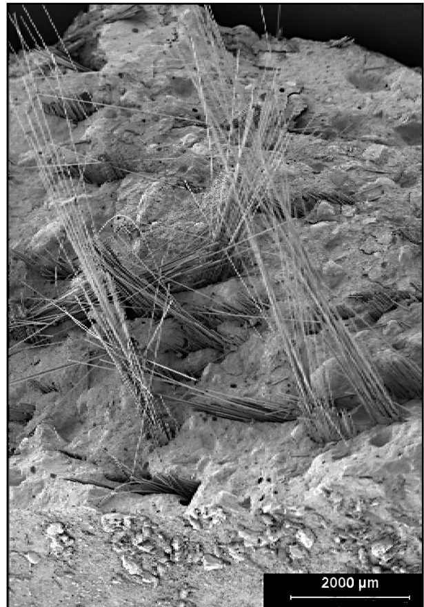
Figura 14. GRC con 10% metacaolín envejecido 80 días. Figure 14. 80-day aged GRC with 10% metakaolin.
