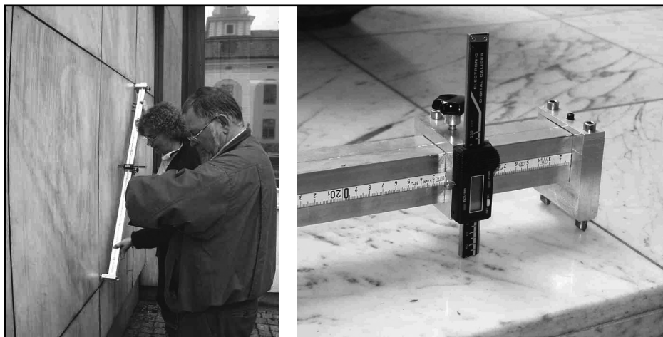
Figura 3. Medición de la combadura con el combímetro. Figure 3. Taking bow-meter measurements.
