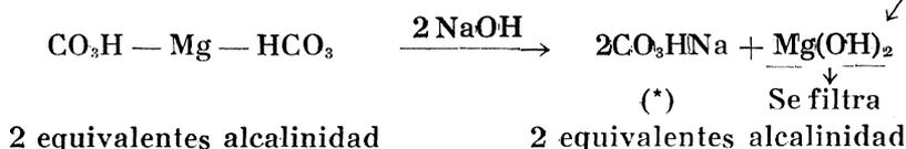
(\*) No se ha tenido en cuenta la posterior reacción de este bicarbonato formado con más sosa, porque al haber sólo la cantidad justa de sosa, si este bicarbonato alcalino formado reacciona, otro preexistente se quedaría sin reaccionar, llegándose a idéntico resultado.
