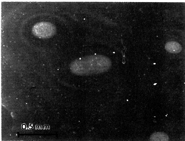
Fig. 1.- Huella dejada por gotas de agua de condensación sobre la superficie de un vidrio silico-sódico-cálcico. Fig. 1.- Fine attack produced by water droplets condensation on the surface of a common soda-lime glass.
