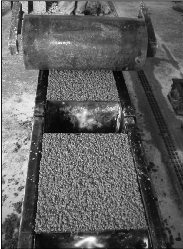
Figura 1. Compactación de las losetas en sus moldes. Figure 1. Set-up for mini-slab specimens.
