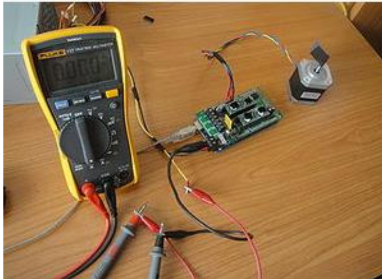
Figura V.36: Ajuste Corriente de los Motores a pasos
