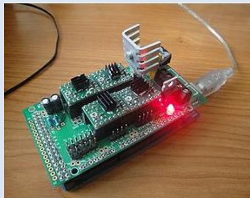
Descargando en la Ramps 1.4 + Arduino Mega 2560
