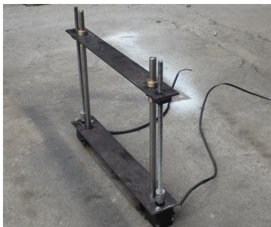
Figura V.31: Mecanismo de Sujeción de la Superficie de Impresión
