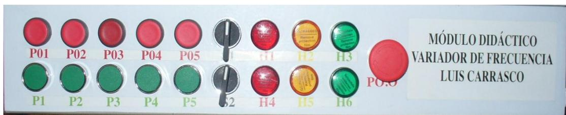
**Figura 3.11:** Colocación de los pulsadores, selectores y lámparas
