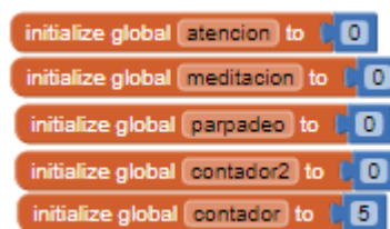
Figura 22-3 Bloque de enceramiento de variables globales
