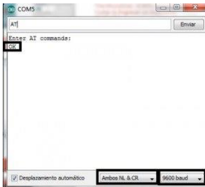
Figura 9-3 Monitor serial con comando AT
