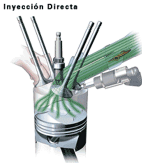
FIGURA 2.1 Ubicación inyector (Sistema Inyección Directa)
