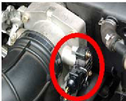
FIGURA 2.27 Ubicación Sensor de Posición de la Mariposa de Aceleración (TPS)
