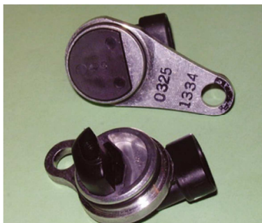
FIGURA 2.70 Sensor de Posición del Árbol de Levas (CMP)
