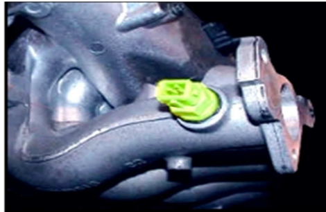
FIGURA 2.37 Ubicación del sensor IAT
