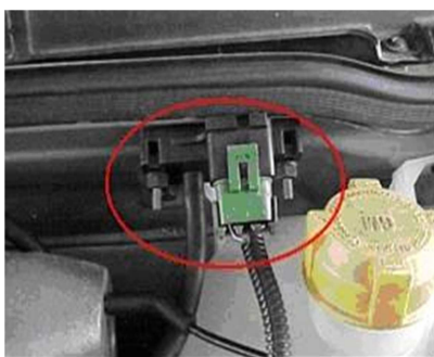
FIGURA 2.41 Ubicación típica del MAP
