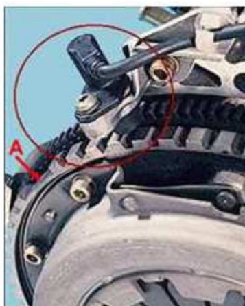
A: Indica la posición angular del cigüeñal al calculador.
