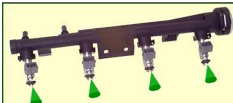
FIGURA 2.9 Esquema Funcionamiento (Sistema Inyección Simultánea)
