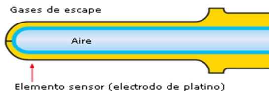
FIGURA 2.57 Esquema interno del Sensor HEGO (Zirconio)
