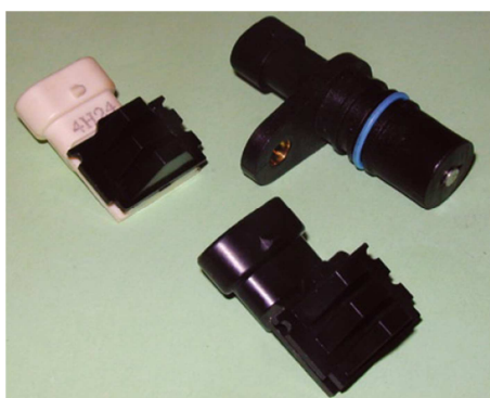
FIGURA 2.64 Sensor de Posición del Cigüeñal (CKP)
