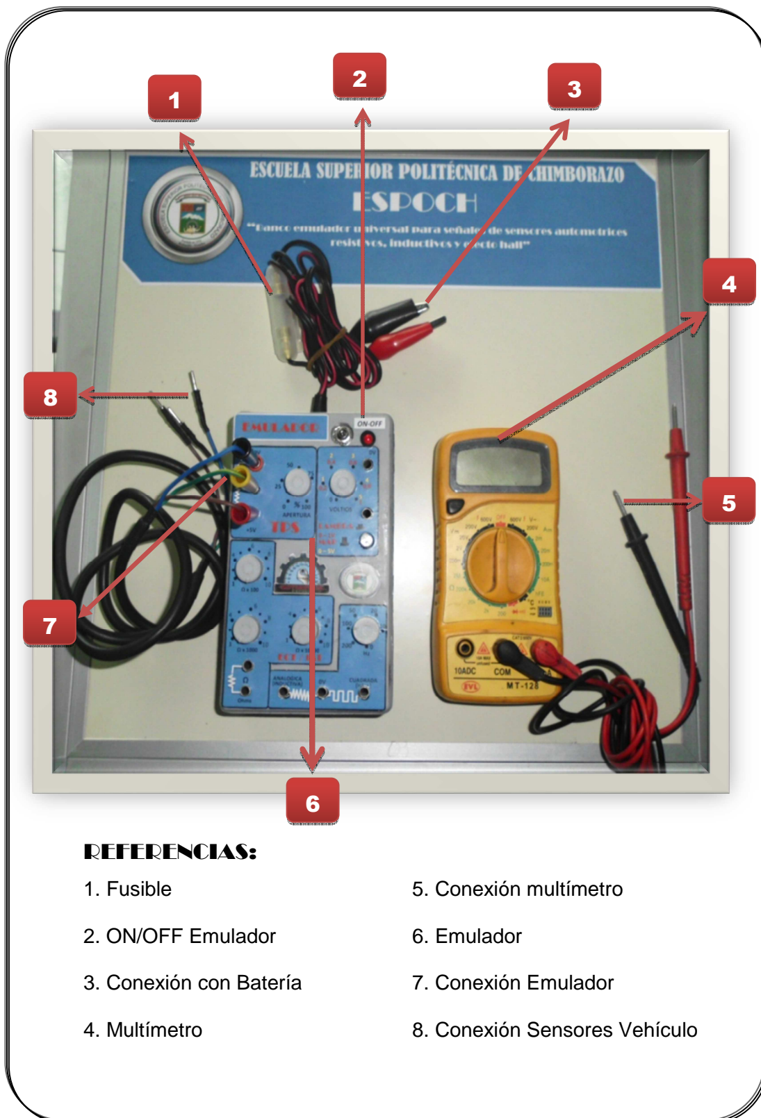
FIGURA 3.11 Distribución de Cables Banco Emulador
