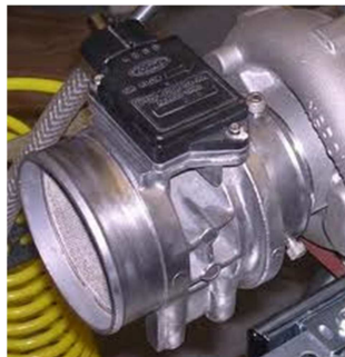
FIGURA 2.47 Ubicación típica del sensor MAF
