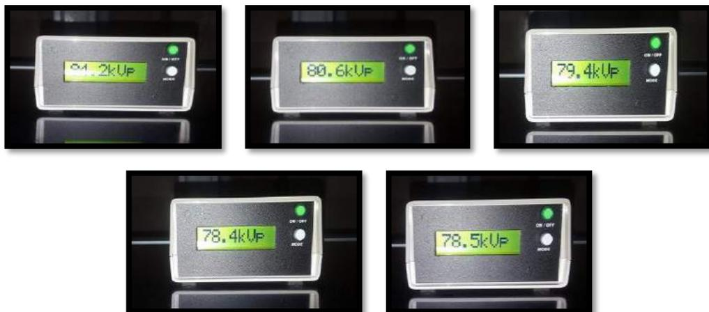
**Fotografía 12-3.** Medidas por repetición de kilovoltaje variando los demás parámetros.
