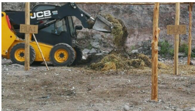
Fotografía 14-2 Volteo mecánico de las pilas Realizado por: Byron Ruiz y Marco Tixe, 2018.
