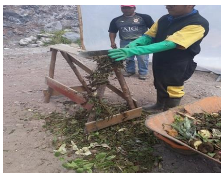
Fotografía 10-2 Triturado de la fracción orgánica Realizado por: Byron Ruiz y Marco Tixe, 2018.
