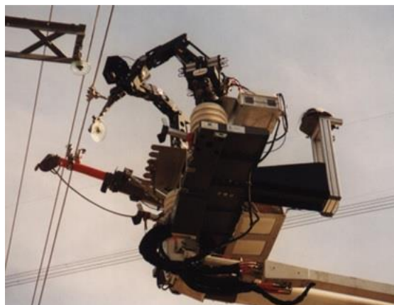
Figura 2.11 ROBTET, robot para el mantenimiento de líneas de alta tensión
