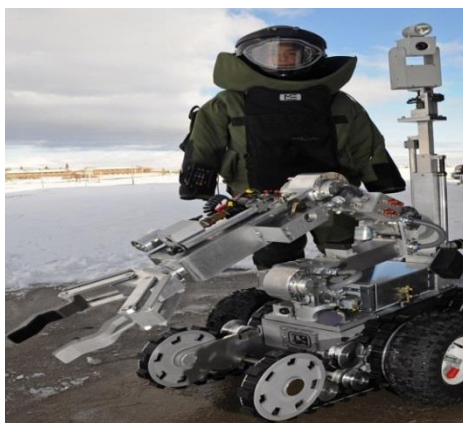
(a) Remotec Andros, robot militar diseñado para contrarrestar amenazas de explosivos improvisados.
