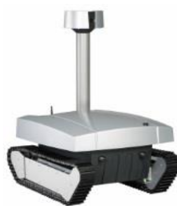
(b) OFRO, robot móvil de seguridad para vigilancia externa.
