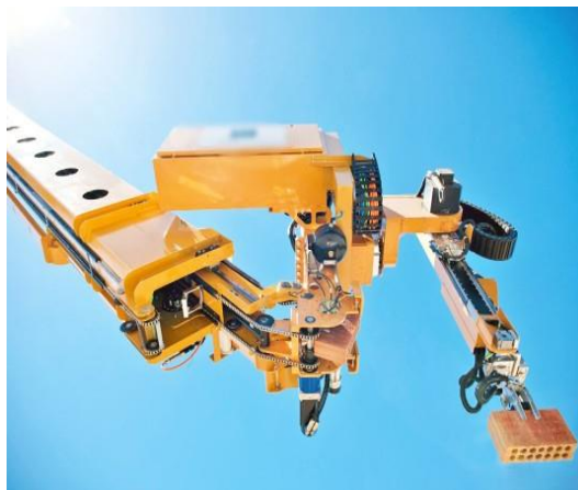
Figura 2.2 HADRIAN, robot empleado en la construcción de edificaciones
