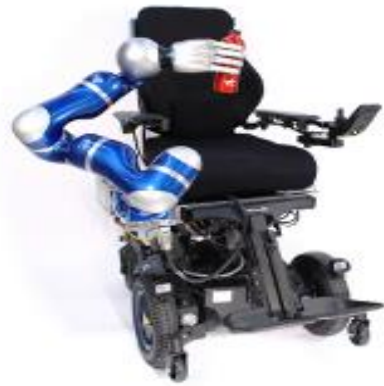
(b) EDAN, Sistema de robótica asistida para personas con problemas de deficiencias motoras.
