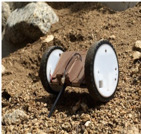
(a) PUFFER, robot plegable plano de exploración de la NASA.
