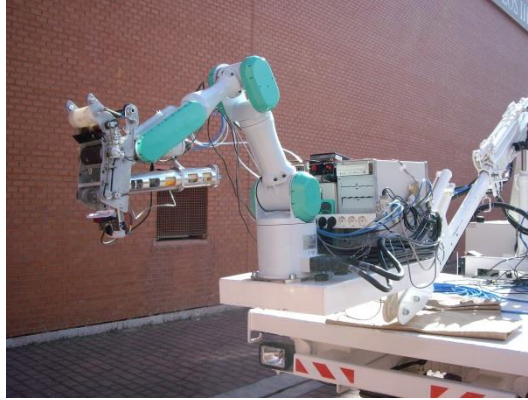
Figura 2.3 Robot para la inspección de túneles Fuente: RoboticLabs UC3M.
