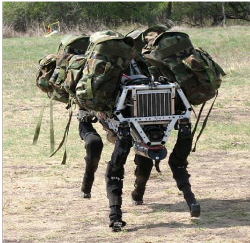
(a) Big dog, robot cuadrúpedo empleado como mula para atravesar áreas difíciles.
