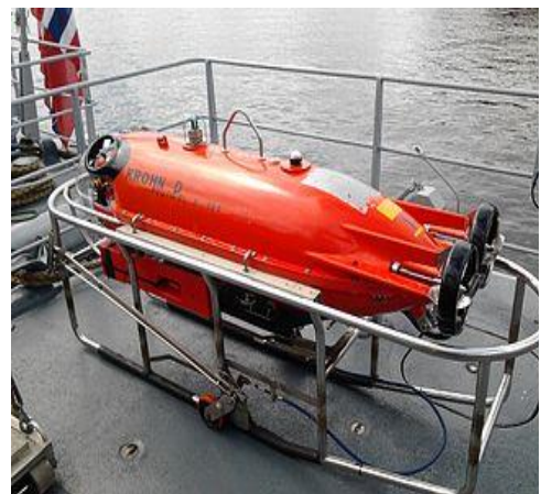
(b) Pluto Plus, robot submarino que identifica y destruye minas.
