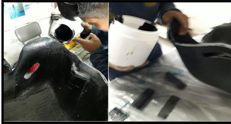
Figura 38-3: Relleno con endurecedor.
