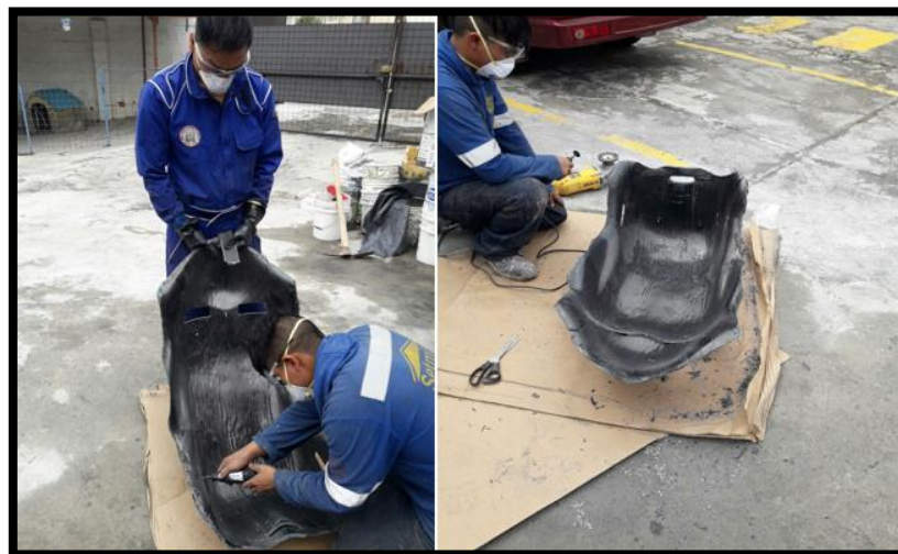
Figura 39-3: Perforación para de cinturón puntos.
