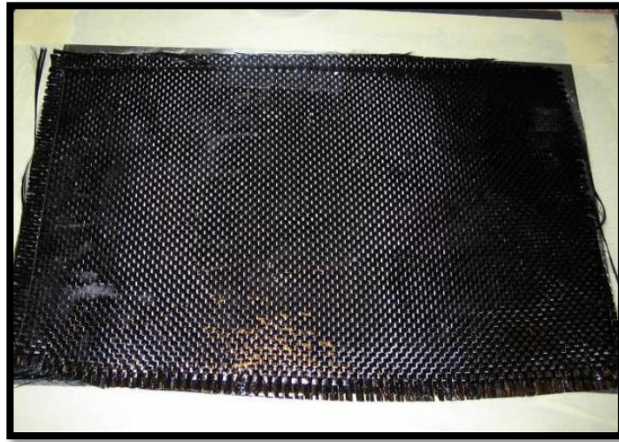
Figura 8-2. Fibra de carbono tejido formando una lámina
