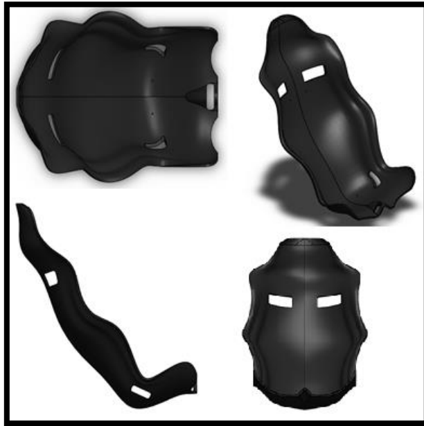
Figura 17-3. Asiento FSAE de fibras de carbono, vidrio y resina epoxi.
