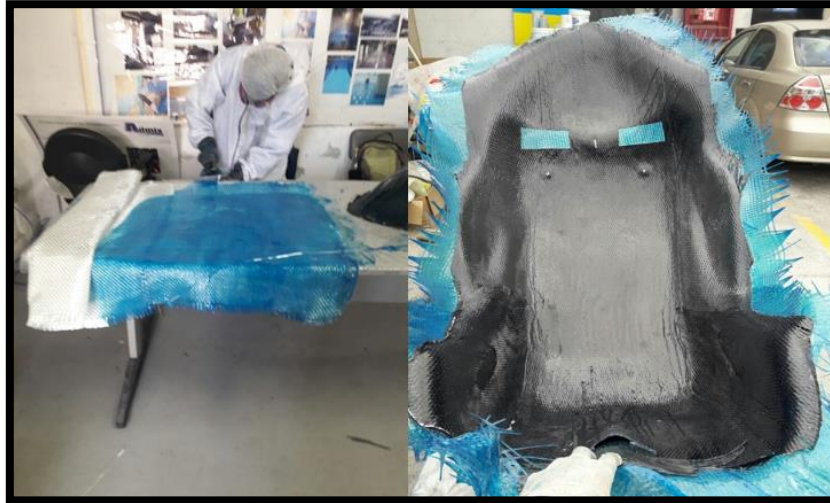
Figura 35-3: Capa de fibra de vidrio para proporcionar espesor y elongación alta.
