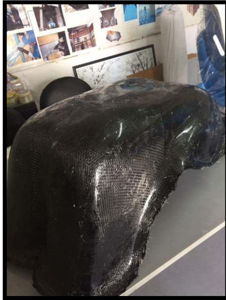
Figura 37-3. Reticulación de 24 horas
