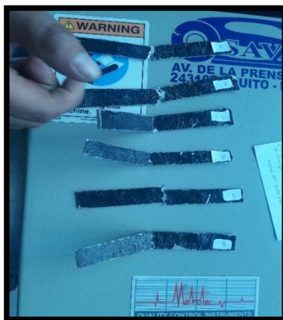
Figura 46-4 Patrones de rotura normalizados carrocería y asiento FSAE.
