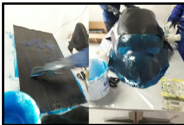
Figura 36-3: Capa de refuerzo.
