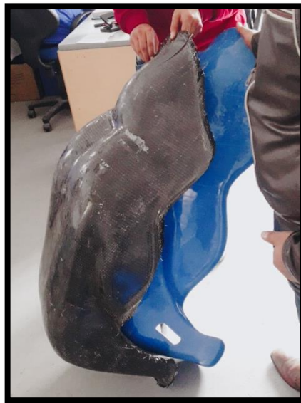
Figura 33-3. Obtención del negativo
