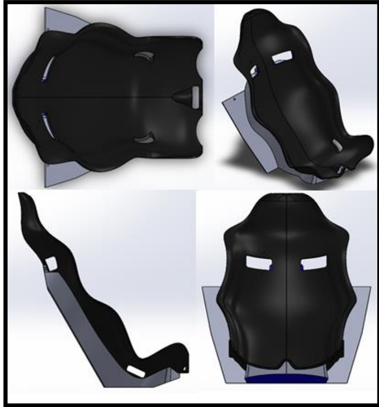
Figura 20-3. Conjunto asiento FSAE de fibras de carbono, vidrio y resina epoxi y firewall de resina de poliéster y fibra de cabuya
