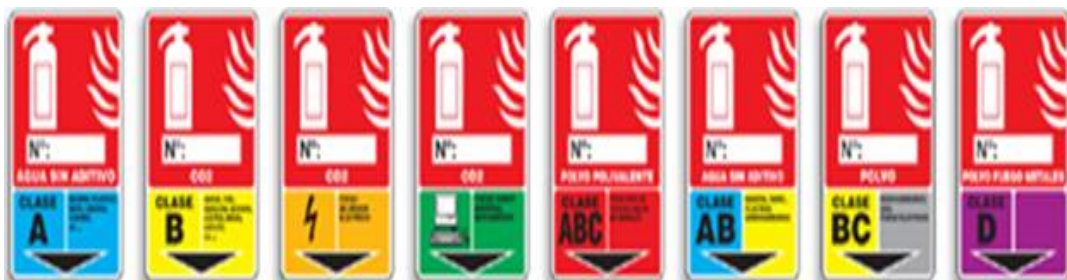
Figura 28. Extintores de acuerdo al tipo de fuego
