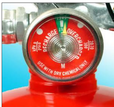
Figura 67. Manómetro del extintor
