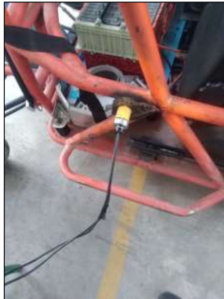
Figura 35-3: Conexión del cargador hacia la fuente de alimentación de energía.
