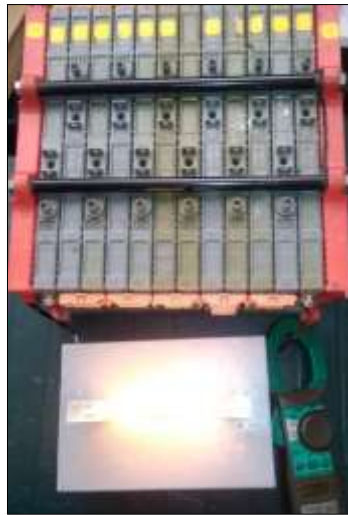
Figura 29-3: Descarga Bloque A a 1.25 A por una hora.
