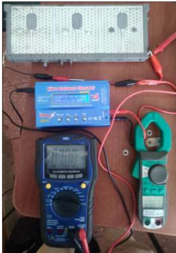
Figura 30-3: Carga a 0.2 celda durante media hora
