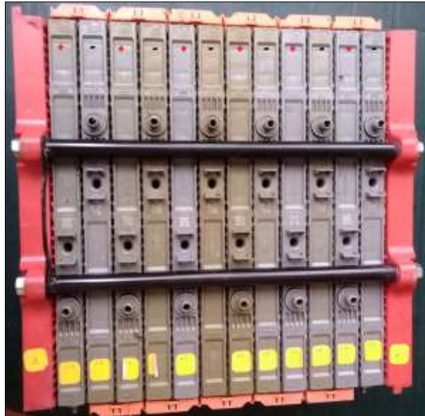
Figura 23-3: Conexión en serie de las celdas de Ni MH
