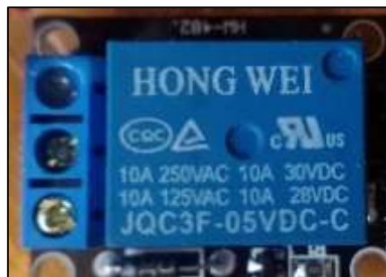
Figura 12-3: Relé utilizado para el accionamiento del extractor
