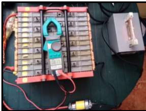
Figura 28-3: Bloque A carga a 0.5 A por una hora.
