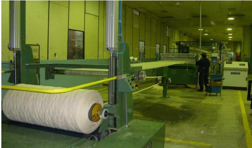
Fig. 3. Cabezal de la Urdidora
