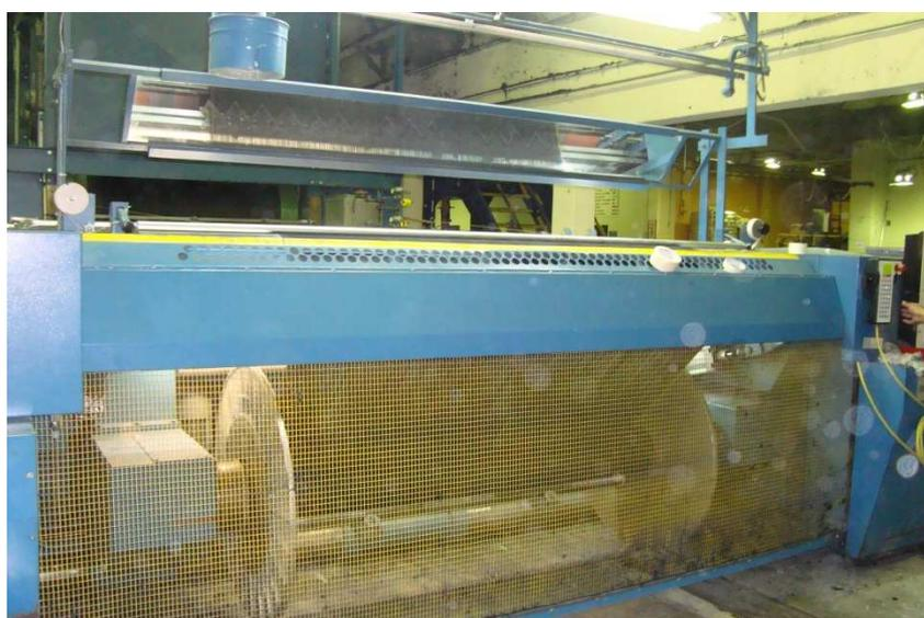
Fig. 5. Cabezal de la Engomadora
