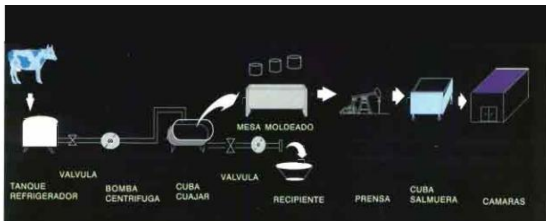
Figura 2-1: Esquema básico de una quesera
