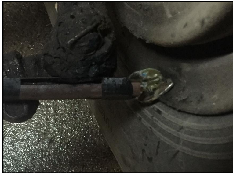
Figura 57: Ubicación del sensor e imán en la llanta del automotor Fuente: Creado por el Autor
