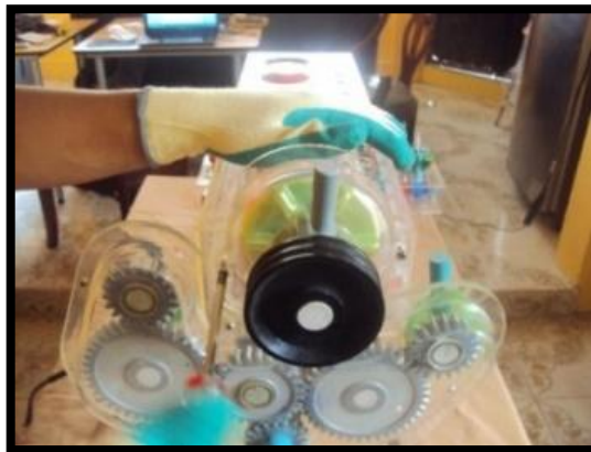
Figura 39. Ensamblaje de la bomba de agua
