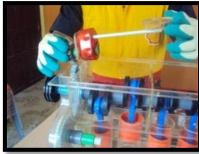
Figura 47. Ensamblaje de la bomba de agua
