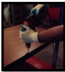
Figura 72. Colocando el MDF sobre la estructura
