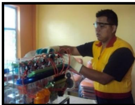
Figura 54. Colocando los inyectores en su posición de montaje
