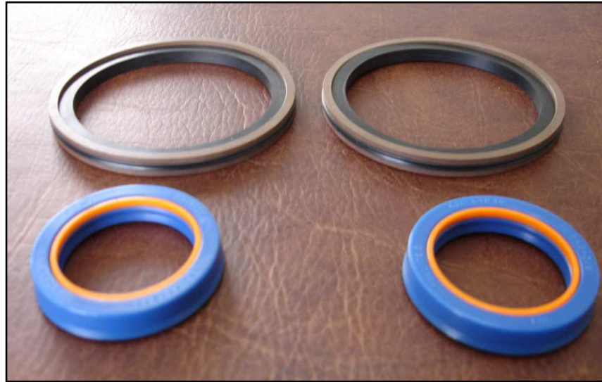
Figura 4.1: Set de retenedores hidráulicos del copiador
