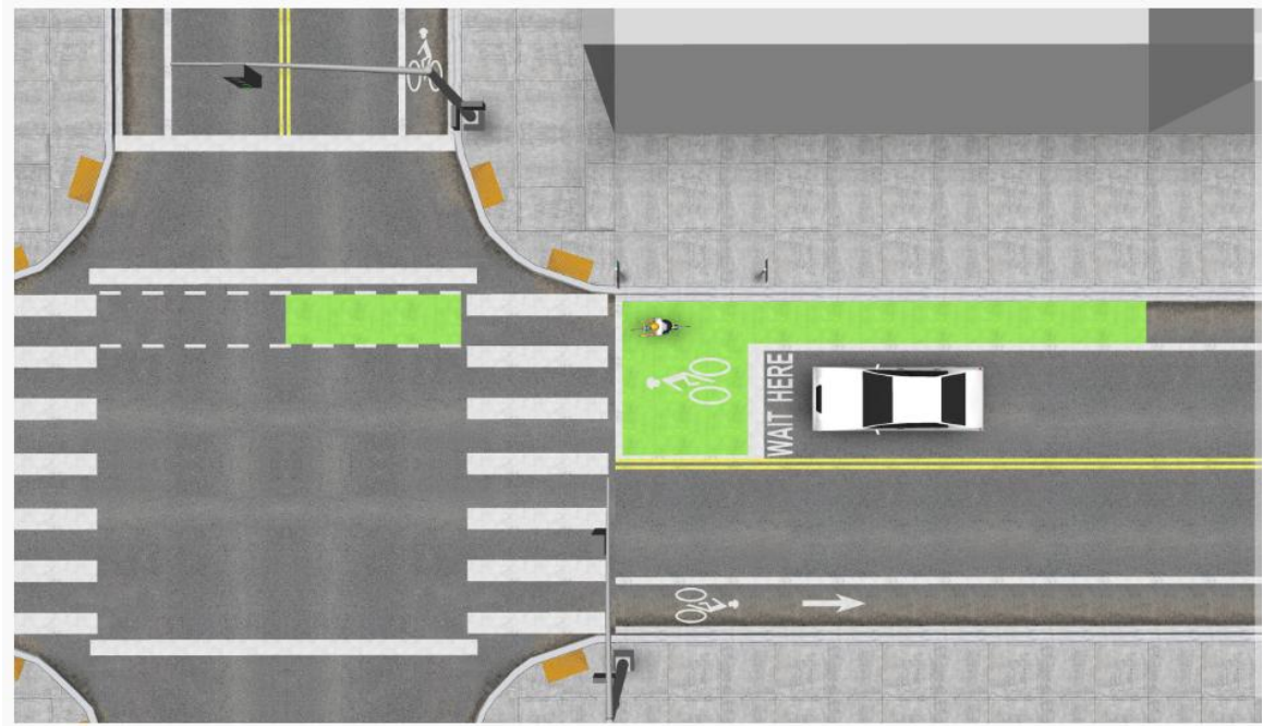
Figura 21-5: Intersección con sistema semafórico
