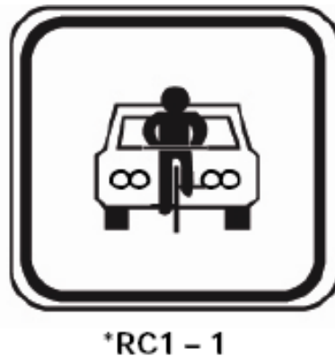
Figura 8-2: Señalización vertical carril compartido Fuente: RTE INEN 004 “Señalización Vial Parte 6. Ciclovías” (Servicio Ecuatoriano de Normalización INEN, 2011).
