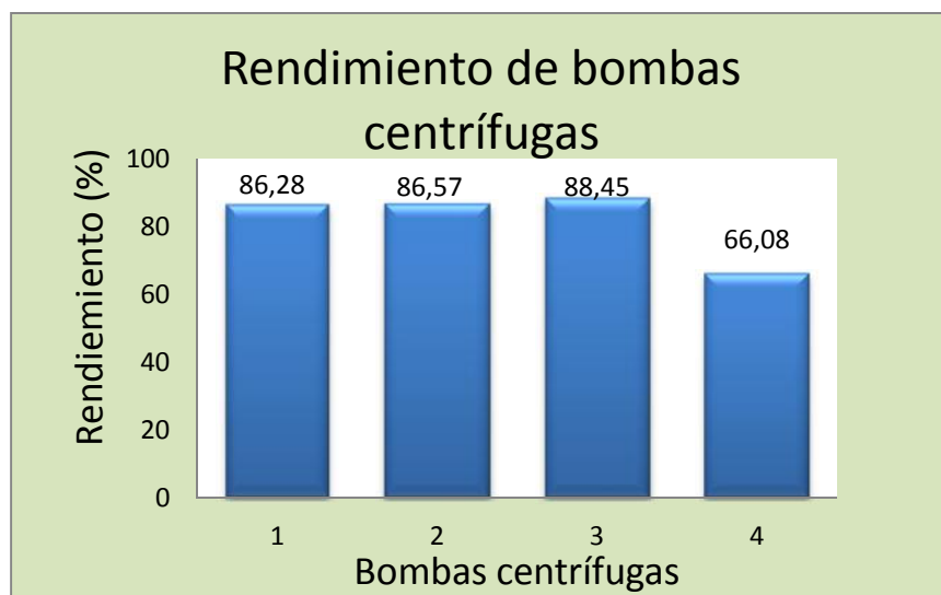
Figura 4.6. Gráfica de rendimientos bombas centrífugas multietapa.
