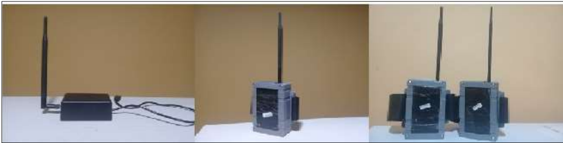
Figura 19-2 Diseño carcasa prototipo WGP Nodo Coordinador, Nodo Router, Nodos Sensores Realizado Por: ROBALINO, Viviana, TAMAYO, Alexis, 2018.
