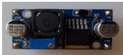
Figura 16-2: Módulo regulador voltaje
