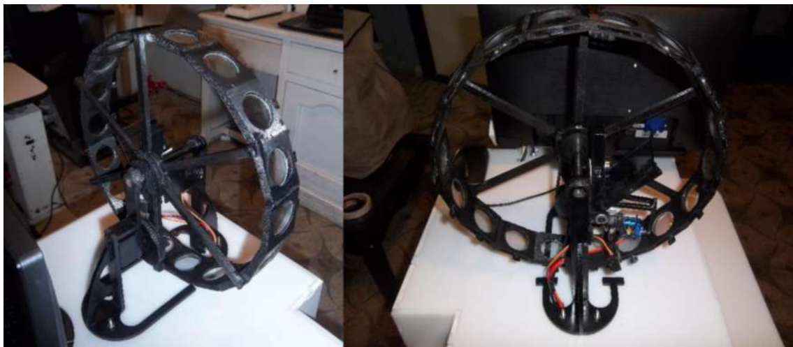
Figura 12-2: Sistema mecánico cambio de lentes y proyección de luz
