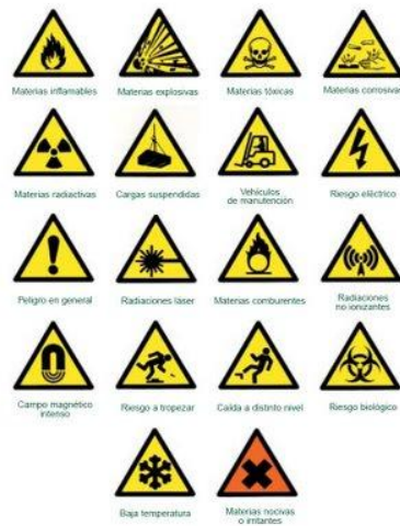
Figura 48. Señales de advertencia
