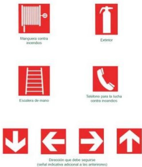
Figura 51. Señales de equipos de lucha contra incendio
