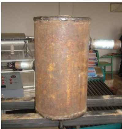
Figura 3.14: Cámara de expansión sin aislante.
