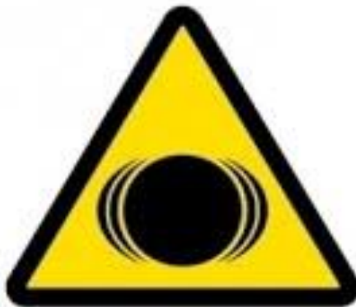
Figura 1-2: Señal de riesgo por vibraciones.
