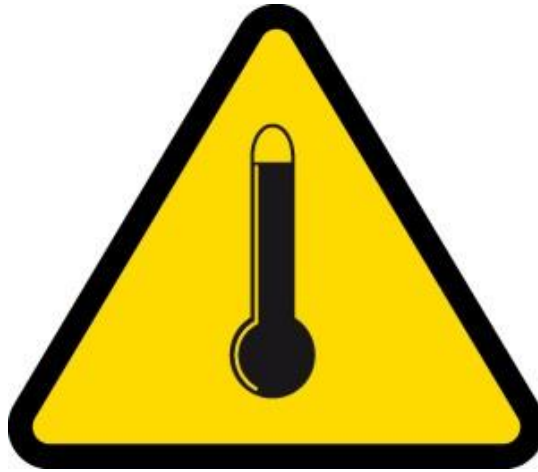
Figura 2-2: Señal de alta temperatura.
