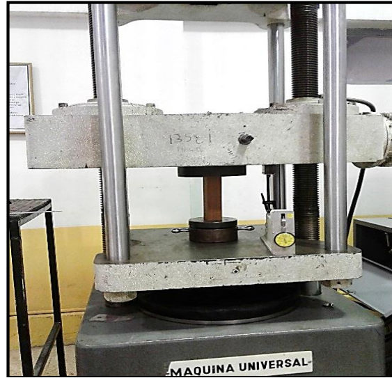
Figura 4. Ensayo de compresión paralela a la fibra con la maquina universal.
