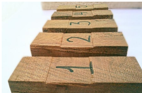
Figura 85. Probetas ensayadas de M. guianensis de compresión perpendicular a la fibra. (Fuente: Autor, 2018)
