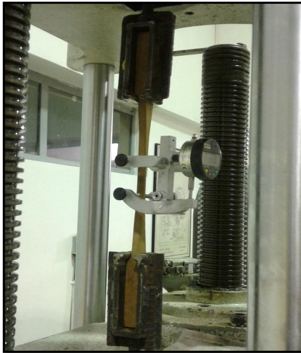
Figura 7. Ensayo de tracción de la madera con la máquina universal
