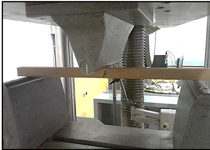
Figura 8. Ensayo de flexión estática de la madera con la maquina universal.
