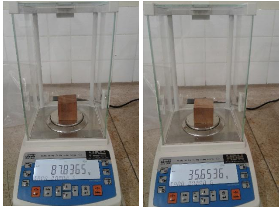
Anexo 27. Medición del peso para porcentaje de humedad.
