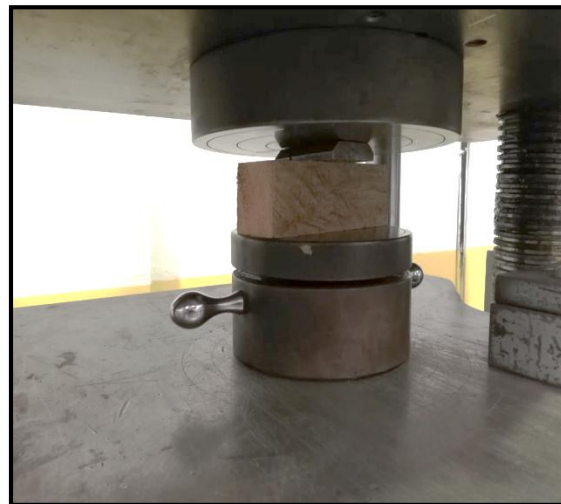
Figura 5. Ensayo de compresión perpendicular a la fibra con la máquina universal
