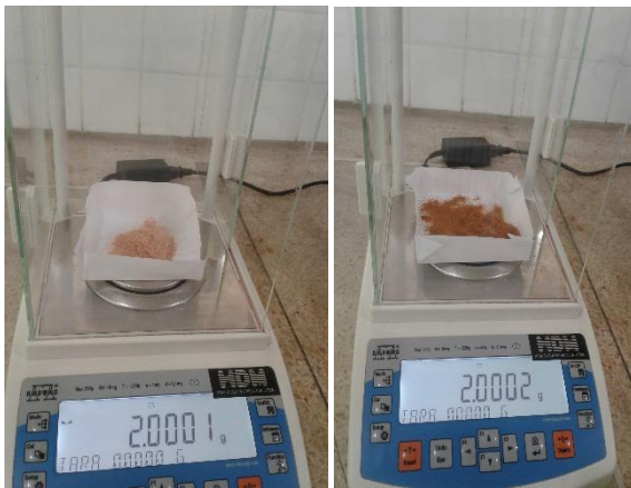
Anexo 28. Muestras para determinar el pH de la madera.
