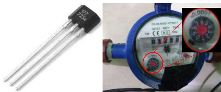
Figura 15-2: Incorporación del sensor de flujo en el medidor convencional
