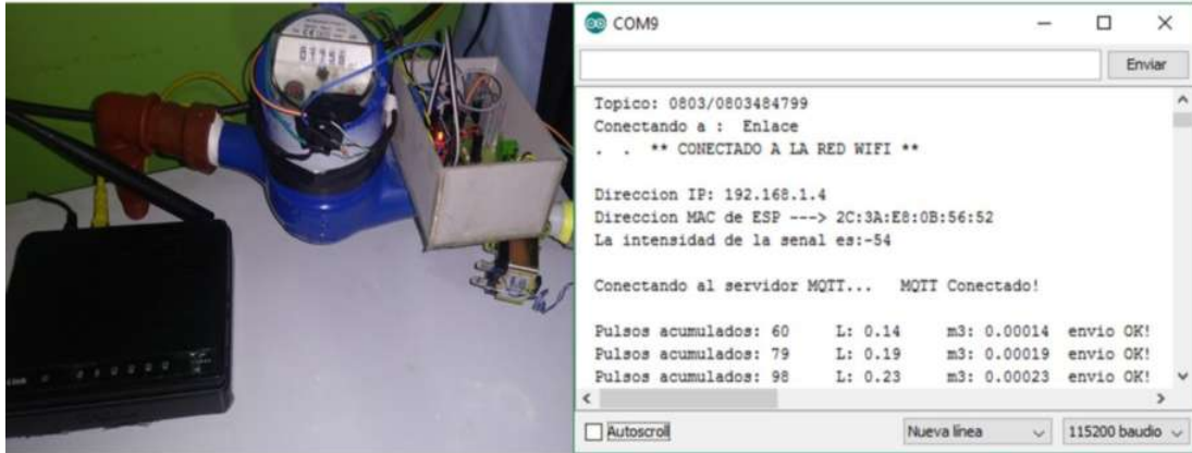
Figura 5-3: Conectividad del medidor inteligente al AP
