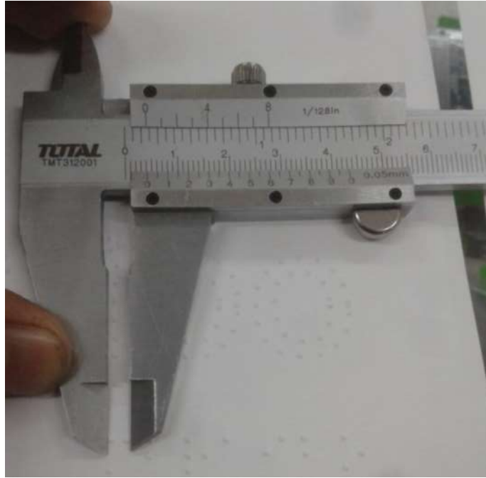
Figura 9-3: Medida de distancia de centro de punto horizontal con calibrador universal.
